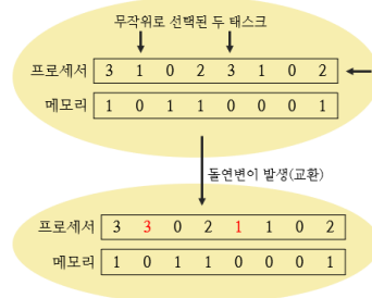
그림 3. 유전 알고리즘의 돌연변이 연산 Fig. 3. Mutation process of genetic algorithms
