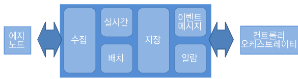
(그림 6) 실시간 Telemetry 측정 및 감시 구성도
