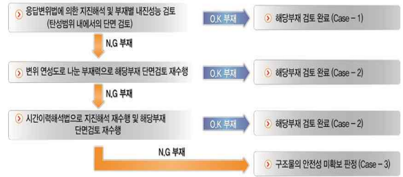
그림 2. 내진성능 평가결과에 따른 내진성능 분류 Figure 2. Seismic Performance Classification by Seismic Performance Evaluation Results
