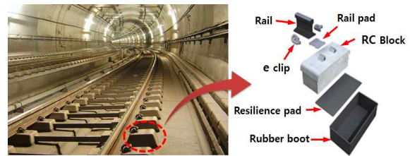
그림 1. 침목플로팅궤도(STEDEF) 개요도 Figure 1. Schematic of sleeper floating track(STEDEF)
