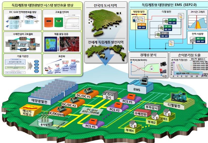
그림 1. 독립계통 태양광발전시스템을 위한 고효율화 및 독립계통 안정화 기술 개념도 Fig. 1. Concept of high efficiency and independent system stabilization technology for PV grid system
