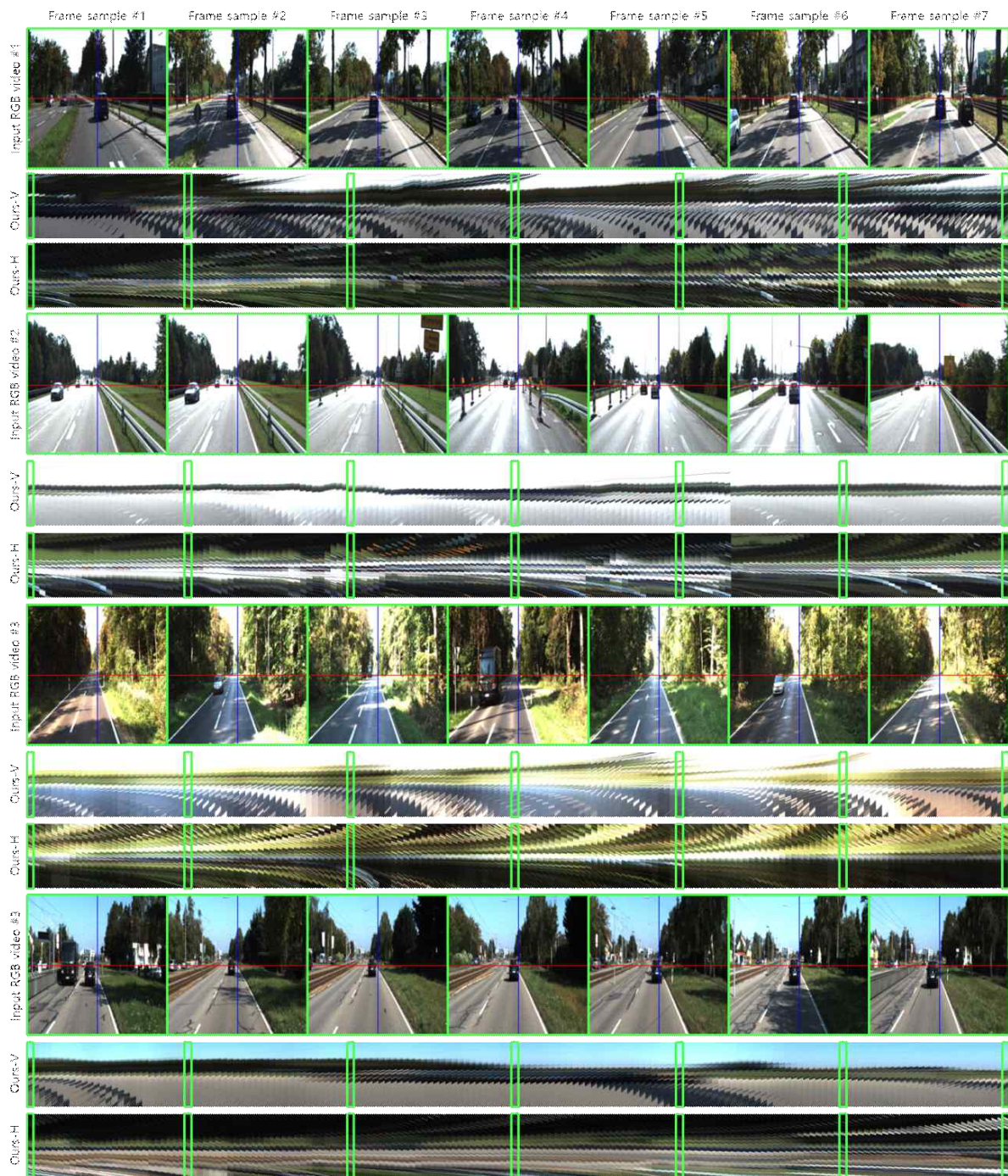
그림 6. 실제 환경에 대한 라이트필드 비디오 합성 결과. 각 비디오는 162개의 프레임을 갖는 KITTI 데이터셋의 영상이다. 3개의 각 행은 입력 단안 비디오 샘플, 수직 EPI 흐름, 수평 EPI 흐름을 나타낸다
