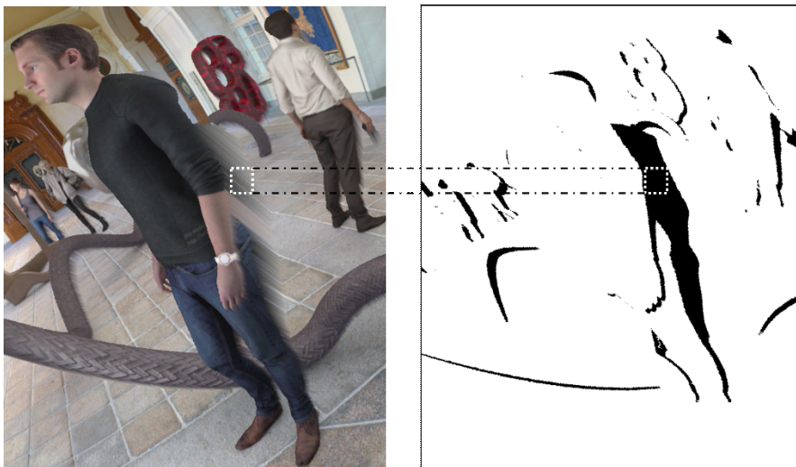
그림 4. 와핑 기반 뷰 간 중복성 제거 예시 Fig. 4. Example of warping-based redundancy removal
