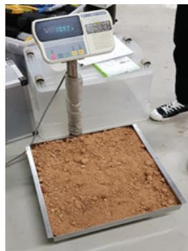
(d) Weigh to determine the moisture loss
