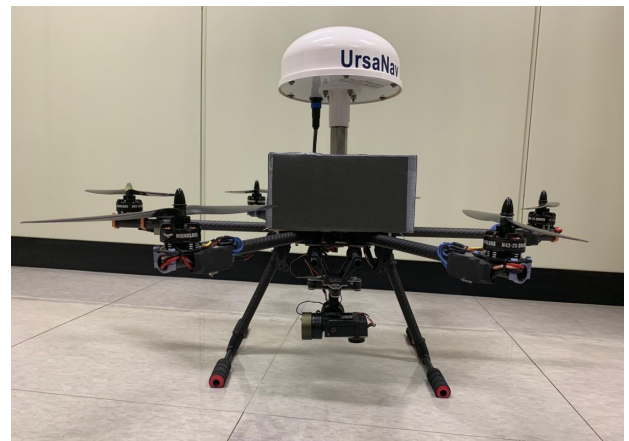
그림 5. 선박기반 측위를 위한 eLoran 안테나, 수신기, vision, IMU 센서를 장착한 UAV Fig. 5. UAV with eLoran antenna and receiver, vision and IMU for ship based positioning.
