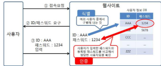
〈그림 3〉 본인인증과 식별ID저장 및 본인확인 절차분석
