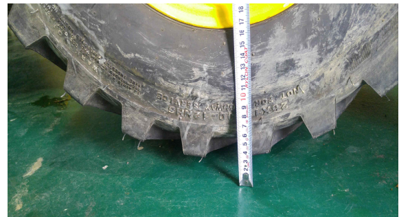
그림 10. 전복률이 100% 이상인 경우의 바퀴 들림 현상 Figure 10. Wheel Lifting Phenomenon When the Overturn Rate is 100% or More
