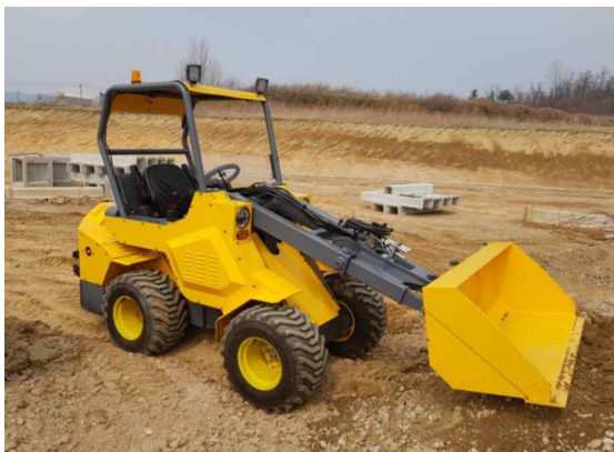
그림 1. 전복 시 보호 구조가 설치된 다목적 로더 Figure 1. Rollover Protection Structured Multi-Purpose Loader
