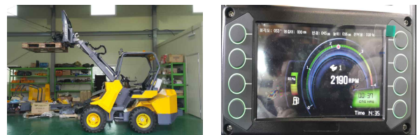
그림 9. 붐 길이, 각도 및 하중에 따른 데이터 전송 Figure 9. Data Transmission for Length, Angle and Payload of the Boom
