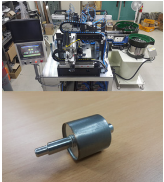
그림 3. 로봇 기반의 생산 시스템 & SUS Wrapping Rotor Fig. 3 Robot-based production system works & SUS wrapping rotor
