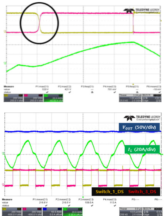
그림 13. M1, M4의 드레인과 소스 간의 소프트 스위칭 실험결과(회로_1의 단일 테스트)
