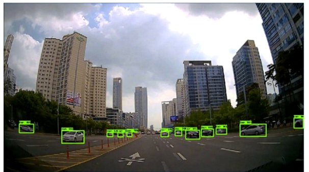
그림 8. 협각, 광각 카메라 데이터 학습 후 검출 영상 Fig. 8. Detection image after learning the data from wide, narrow-angle
