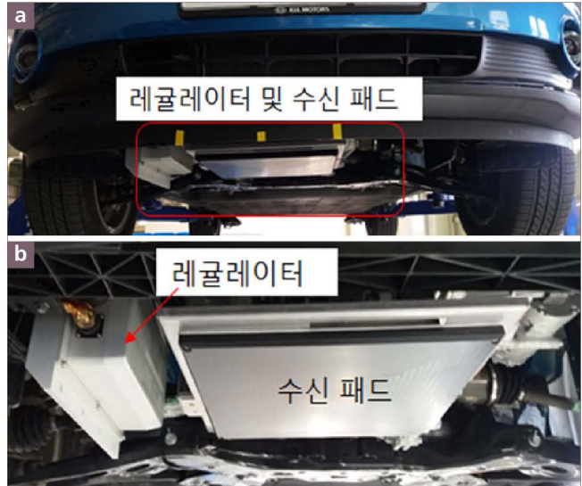
그림 6 무선충전기 차량 부 (a) 레귤레이터 및 수신 패드 (b) 확대사진
