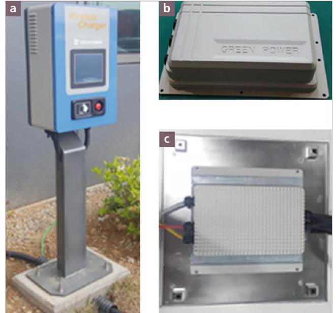
그림 4 전기자동차 무선충전기 사진 (a) 지상부, (b) 차량부, (c) 차량부 장착패키지
