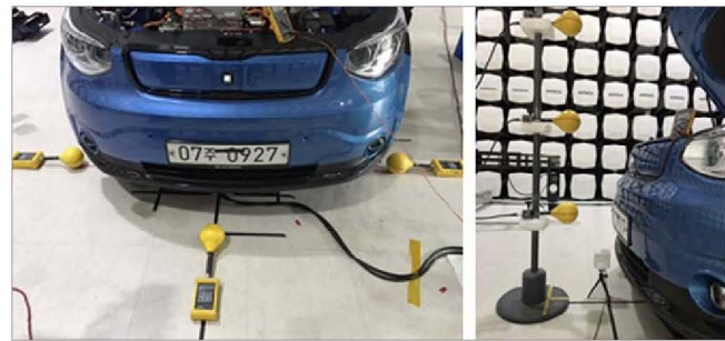
그림 7 전기자동차 무선충전기 전자파 측정 사진
