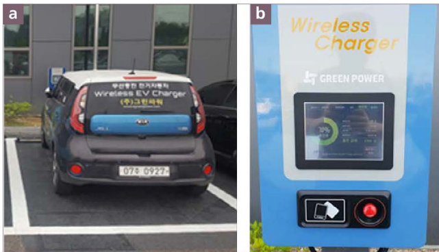
그림 9 전기자동차 무선충전 사이트 사진 (a) 무선충전 사이트, (b) 무선충전기 충전화면
