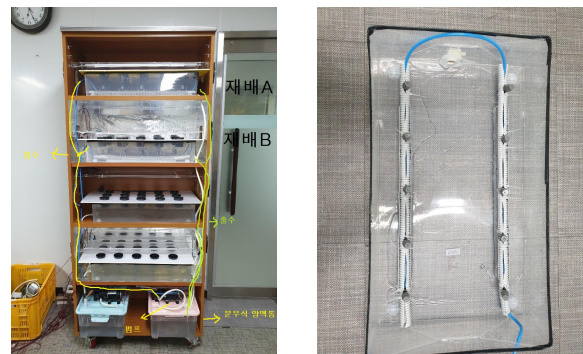
Fig. 7. Aeroponics nutrient control composition diagram. 그림 7. 분무식 양액제어 구성도
