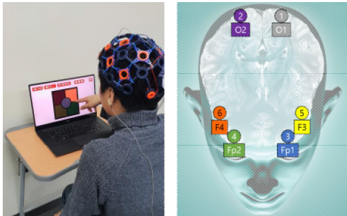
그림 1. (a) EEG 측정 모습 (b) 전극 부착 위치 Fig. 1. (a) EEG measurement (b) Electrode attachment positions
