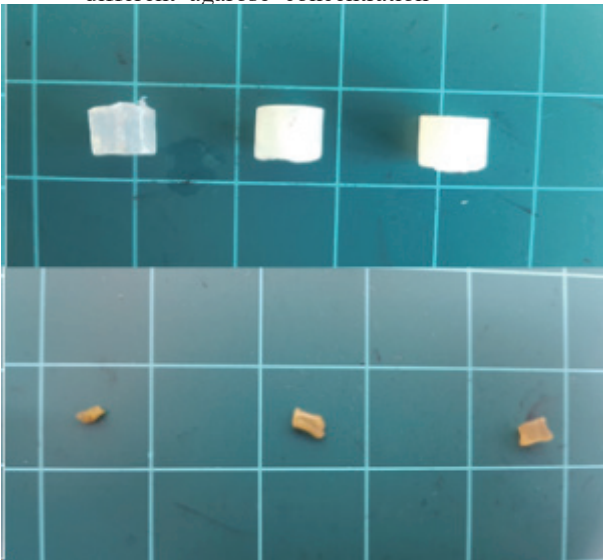
Fig. 4 Appearance of solidified ethanol fuel before dry (up) and after dry (down) 을 확인하였다. 이후 실험에서는 경도가 충분하지 못한 0.5 % 연료는 제외하였다.
