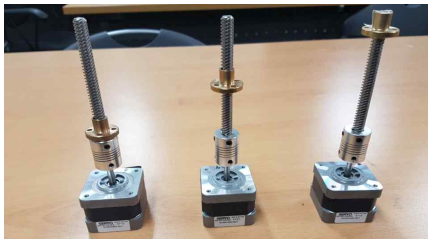
<그림 5> 스텝 모터에 연결한 스크류 샤프트를 이용한 높이 조절
