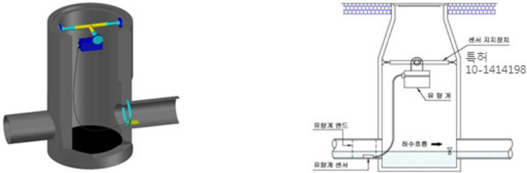
Fig. 1. Flow Meter Installation
