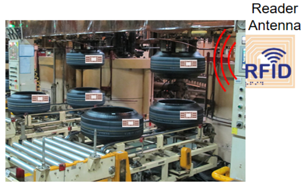
그림 1. 타이어 생산공장에서 RFID 적용 사례 Fig. 1. RFID system in tire manufacturing.
