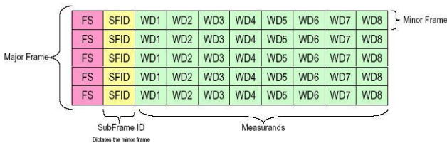
그림 2. 텔레메트리 PCM 프레임 구조 Fig. 2. Structure of telemetry PCM frame.
