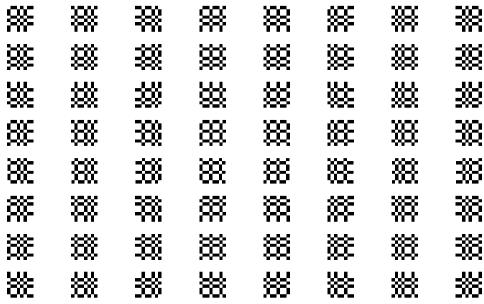
그림 3. 1차원 CAT 기저 함수 Fig. 3 1D CAT basis function
