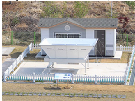
그림 3. 클러터 펜스를 갖춘 UHF 윈드프로파일러 LAP3000
