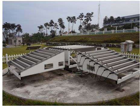
그림 1. 클러터 펜스가 없는 UHF 윈드프로파일러 PCL1300
