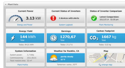
그림 9. 마이크로 인버터(PV-MIC)의 모니터링 시스템 Fig. 9. Monitoring system of micro-inverter(PV-MIC)
