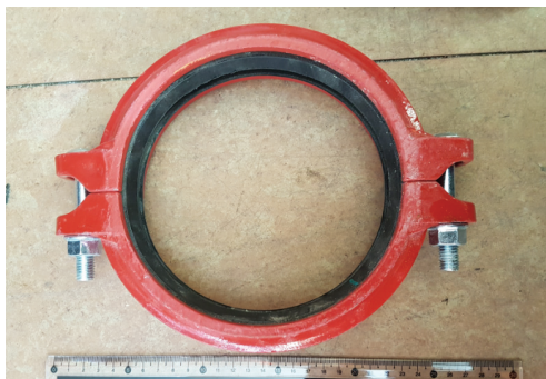
[사진 1] 가스배관의 내진 고정장치
