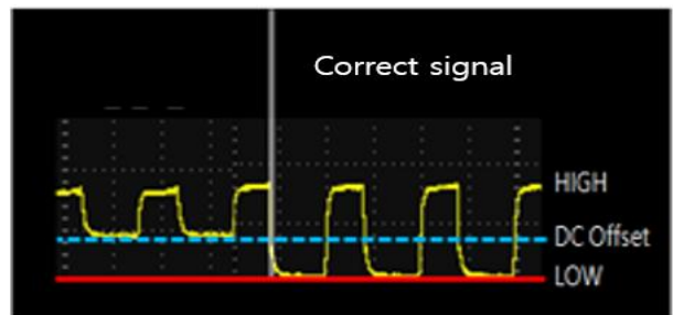
그림 6. 주변 광 간섭을 받는 신호 / 정상 신호 Fig. 6. Interfered signals by ambient light / Normal signal.
