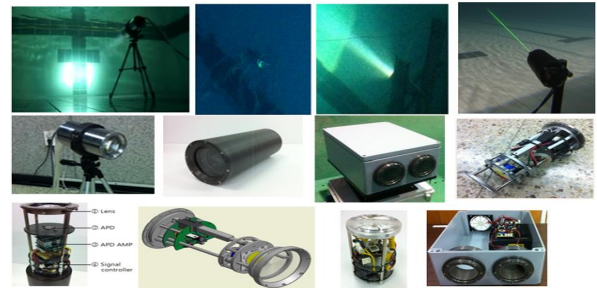
그림 1. 한국해양대학교 개발 광무선통신 모뎀 Fig. 1. Optical modems of KMOU.
