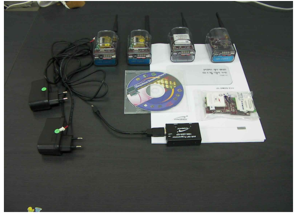
그림9. 본 연구에 사용한 모듈형 USN 무선 센서 Fig.7. Modular USN Sensor for this Reserch
