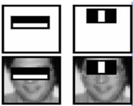
그림 2. Haar 알고리즘 특징 추출. Figure 2. Extraction of Haar Algorithm Features.
