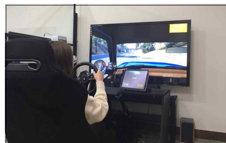
그림 2. 시뮬레이터 실험 환경 (주행 스크린과 보조 스크린) Figure 2. Simulator experimental setup (Main and secondary screens)
