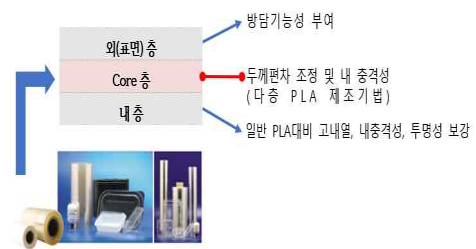
그림 3. 복합기능성 PLA 시트다층구조 Figure. 3. Multi-functional PLA sheet multi-layer structure
