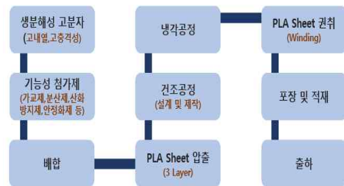
그림 4. 시트 공정도 Figure. 4. Sheet process drawing
