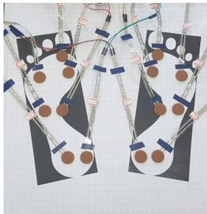
그림 4. 족압 측정을 위한 FSR 센서 배열
