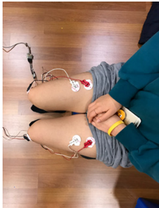
그림 3. 유선 근전도(BIOPAC Systems MP150) Fig. 3. Wired electromyography(BIOPAC Systems MP150)
