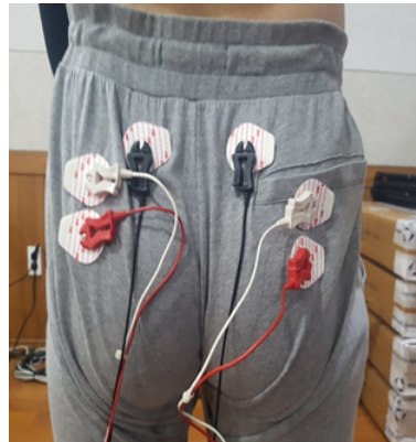
그림 3. 유선 근전도(BIOPAC Systems MP150) Fig. 3. Wired electromyography(BIOPAC Systems MP150)
