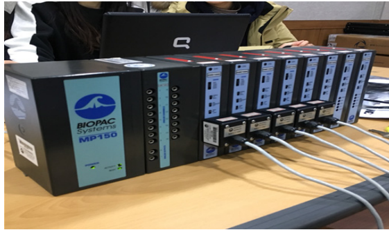
그림 3. 유선 근전도(BIOPAC Systems MP150) Fig. 3. Wired electromyography(BIOPAC Systems MP150)
