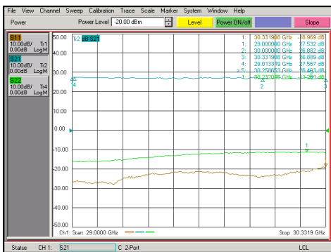
그림 20. 선형 전력 이득 측정 파형 Fig. 20. Linear power gain measurement waveform
