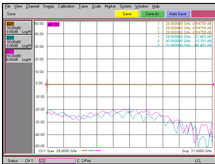
그림 16. 입력부 및 출력부 back-to-back 결합 측정 : 반사 손실 및 삽입손실 Fig. 16. Input & Output back-to-back measurement : return loss & insertion loss
