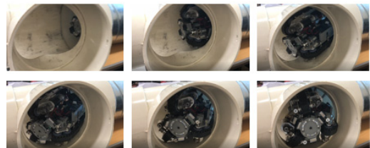
그림 20. T 덕트 주행 그림 Fig. 20. Driving on T-type duct
