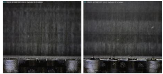
Fig. 16 Surface of CFRP (K40UF) Left(Tetrabond), Right(Tisinós)
