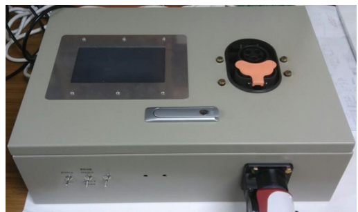
그림 9. 전기 자동차 충전기의 고장진단을 위한 휴대형 스마트 시험기
