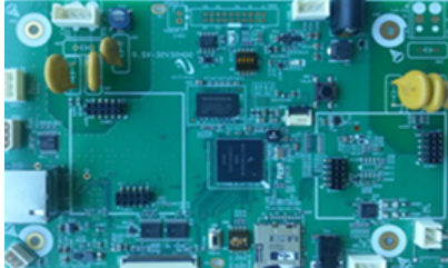
그림 10. EV PLC control 보드 Fig. 10 EV PLC control board
