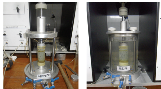
(c) Sample molding complete (d) Sample saturation complete
