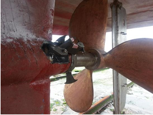
Fig. 3. Propeller rope cutter (Jejudominilbo, 2015).
