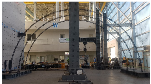
〈그림 7〉 격자지보재 실물재하시험 전경
