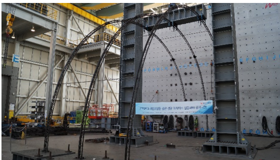
〈그림 7〉 격자지보재 실물재하시험 전경
