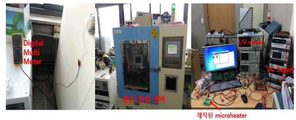
그림 5 항온항습 챔버내 온도센서 측정 및 마이크로 히터 측정 셋업
