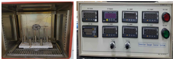
(b) 환경온도 & 인버터서지 적용의 절연과괴 수명 시스템
