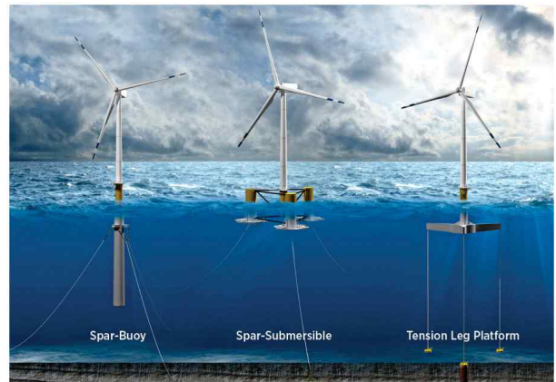
그림 2. 부유식 해상풍력발전시스템의 부유체 주요 형식.
