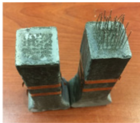
(d) USL49 After Tests (Smooth Fibers)
