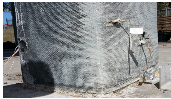
(d) no visible damage on NSM-FRP retrofit column
