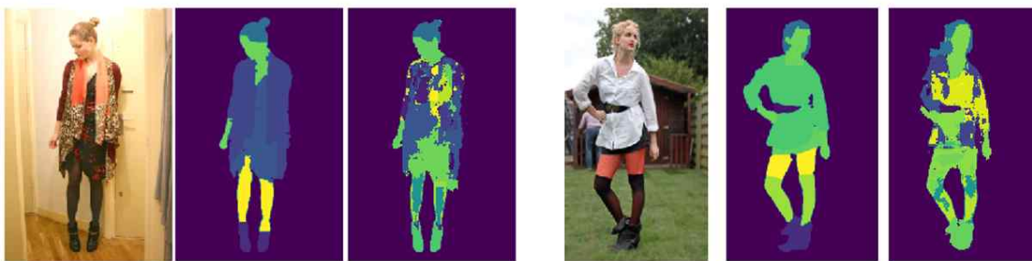
그림 8. 배경과 인물의 영역 분류에는 성공하였으나, 오브젝트의 디테일을 추론하지 못한 사례 Fig. 8. Successful classification of the background and person, but the case of not inferring the detail of the object
