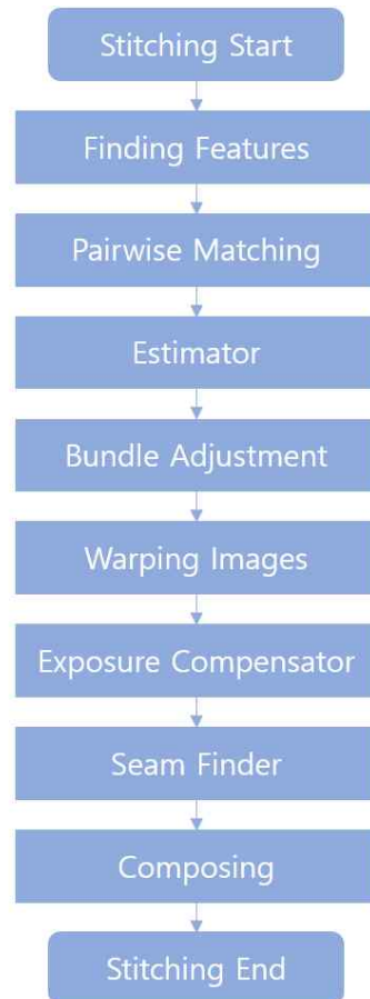
그림 2. 360 VR 영상 합성 과정 Fig. 2. Flowchart of the 360 VR image composition algorithm
