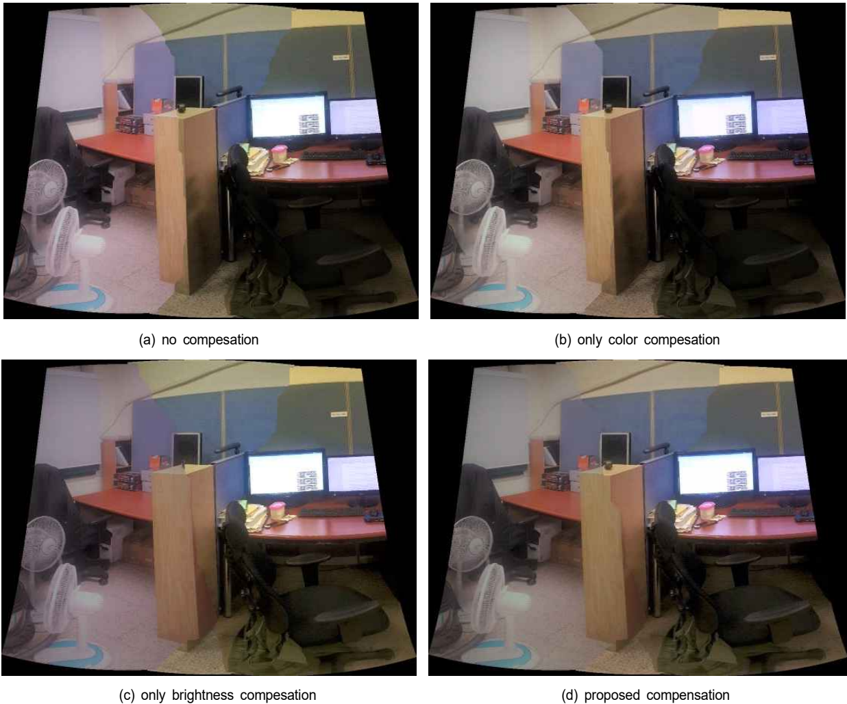
그림 15. 밝기와 색상 보정이 모두 필요한 영상의 스티칭 결과
