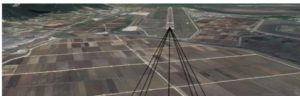
그림 5. 활공각제공시설(glide path) 드론점검 경로 Fig. 5. Drone flight route for glide path inspection.
