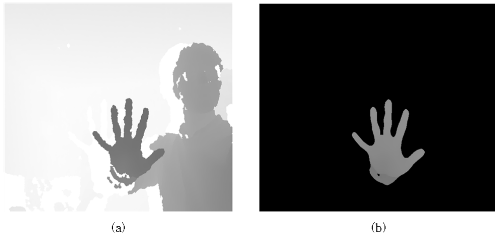
Fig 3. Hand region extracted through preprocessing. (a) Input depth image, (b) Extracted hand region 그림 3. 전처리를 통해 추출된 손 영역 (a) 입력 깊이 이미지, (b) 추출된 손 영역
