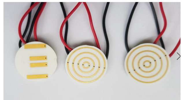
Fig. 4. Gold electrode type printed on ceramic. 그림 4. 세라믹에 플린팅 된 Gold 전극타입
